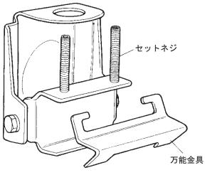
①セットネジをゆるめてぬいた後、 万能金具を基台に差し込みます。
