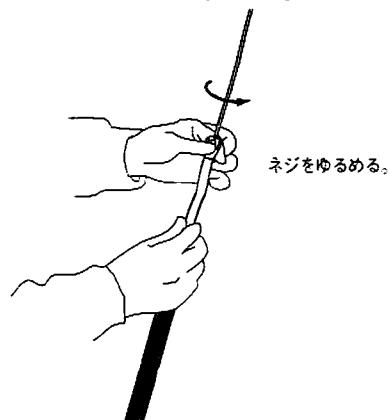
②ファイバーエレメントを金具の中に入れる長さにより周波数が変化します。エレメントを伸ばすと共振周波数が下がり、逆に縮めると共振周波数は上がります。通常の使用状態では、ファイバーエレメントを中間（最短から約5cm伸ばす）にしたときに、アマチュアバンドの中心付近がSWR最良点となるように設定しています。
