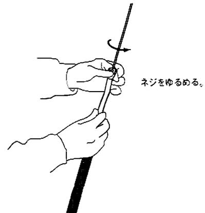
②ファイバーエレメントを金具の中に入れる長さにより周波数が変化します。エレメントを伸ばすと共振周波数が下がり、逆に縮めると共振周波数は上がります。通常の使用状態では、ファイバーエレメントを中間（最短から約5cm伸ばす）にしたときに、アマチュアバンドの中心付近がSWR最良点となるように設定しています。
