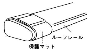
③ 右図のように保護マットの上に基台を取り付けます。ナットはスパナでしっかりと締め付けてください。
