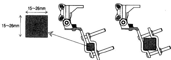
③ 断面の高さ  $32$  mm 以下、幅  $50$  mm 以下のルーフレール
