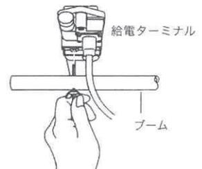
もう一方の給電ターミナルも同じようにブームへ取付けます。下図のようにマatchingエレメントの向きを確認して取り付けてください。給電ターミナルを結ぶケーブルはフェーズラインと呼ばれます。フェーズラインは梱包時に180°ねじってありますのでそのまま取り付けます。フェーズラインをねじりすぎると断線の原因となります。
