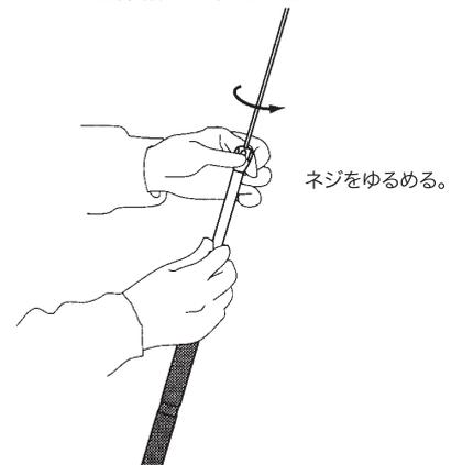
②ファイバーエレメントを金具の中に入れる長さにより周波数が変化します。エレメントを伸ばすと共振周波数が下がり、逆に緩めると共振周波数は上がります。通常の使用状態では、ファイバーエレメントを中間（最短から約5cm伸ばす）にしたときに、アマチュアバンドの中心付近がSWR最良点となるように設定しています。
