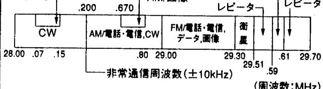
注／29.00MHzから29.30MHzまでの周波数は、外国のアマチュア局とのAM/電話・電信およびCWによる通信に使用することができる。
