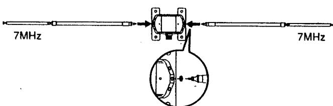
エレメントに付属の平ワッシャーを通して、本体にねじ込みスパンなどで締め付けてください。
