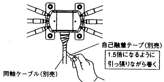
同軸ケーブルは1回ループを作りコネクター部に力のかからないようビニールテープなどで止め、マストに沿わせて固定します。
