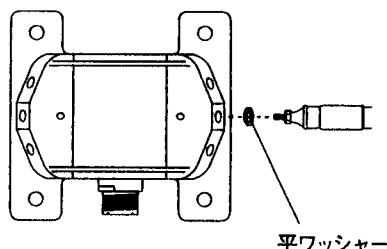
③次に21MHzエレメントを取り付けます。21MHzエレメントは必ず図の位置に取り付けてください。
