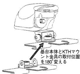
\* 基台が車体等に接触して角度調整が出来ない場合には、基台本体とKTHマウント金具の取付けを180度変えてください。
