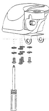
③ 基台本体底面のビスを緩め、基台本体を横に回転させてアンテナの倒れる方向を調整します。また、50度以上回転させる場合には、基台本体とベース金具を一度取り外して向きを変えてください。
